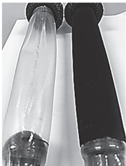
図6. 耐久試験後の人工筋肉の内部。(左) 植毛なし (資料番号2)。(右) 植毛あり (資料番号5)。植毛なしの従来の人工筋肉ではメッシュスリーブの様子が転写する程にゴムチューブが傷ついているが、植毛ありの人工筋肉では植毛層に守られたゴムチューブに傷跡は無かった。
